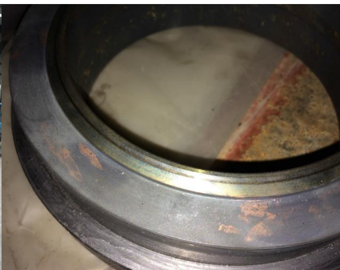
图 4 华能沁北电厂 #12 机高压旁路阀改造后，运行一年后，阀座密封面完好无损
