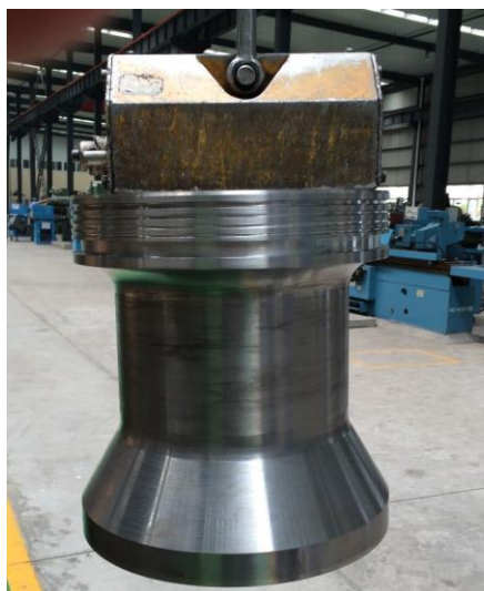
图 3 改造后的低压旁路阀阀芯（CCI 公司产品）
