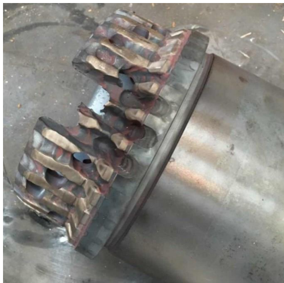
图 6 华能安源电厂高压旁路阀阀芯损坏情况（使用不到一年）
