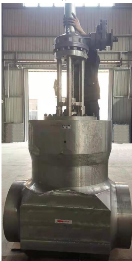
图 39 安装好的减温减压装置。其中，减温水取自主给水，减温水调节阀的压差很大。自 2015 年 3 月开始运行到现在，调节阀运行很好，没有更换零部件。整套系统中的疏放水阀（手动和气动）、电动闸阀、抽汽止回阀都运行良好。注：本系统一年启停 300 次左右。
