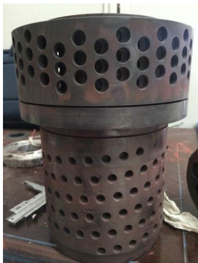
CV 阀套（节流孔可从外侧直接看通）
