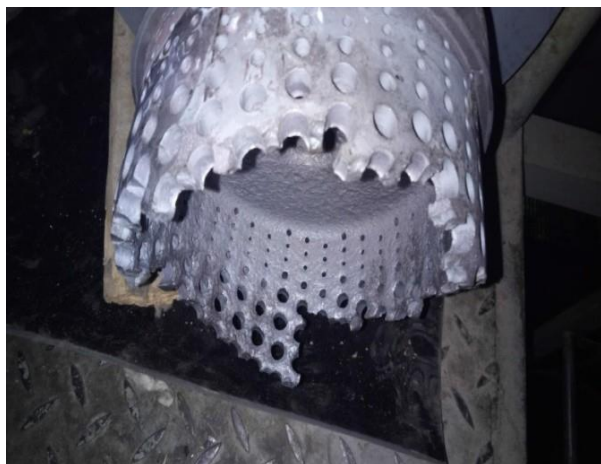
图 20 华能莱芜电厂#6 号机组 高压旁路阀阀芯节流套损坏情况
