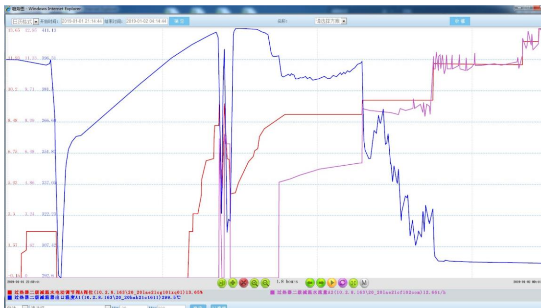
图 50 国华徐州电厂 2X1000W 超超临界机组原进口过热器减温水调节阀在机组启机时，投入过热器减温水调节阀（此时调节阀开度很小）时，主蒸汽温度波动情况（红线是过热器减温水调节阀的阀位，蓝线是减温器出口温度）
