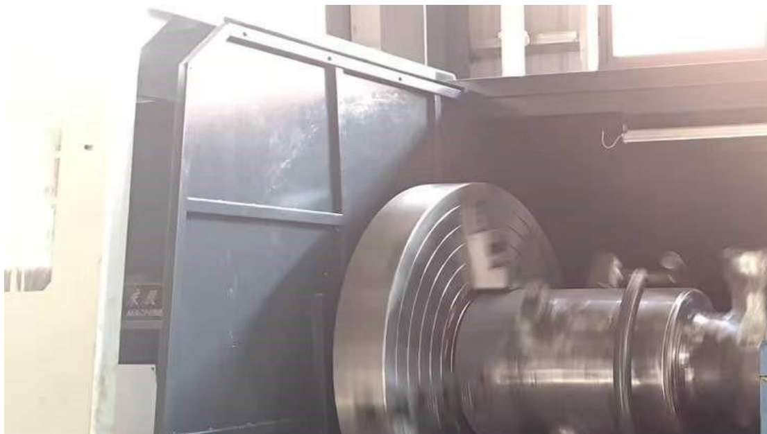
为秦皇岛电厂设计制造的高压旁路阀（阀体正在加工的照片。旁路系统已经运行）
