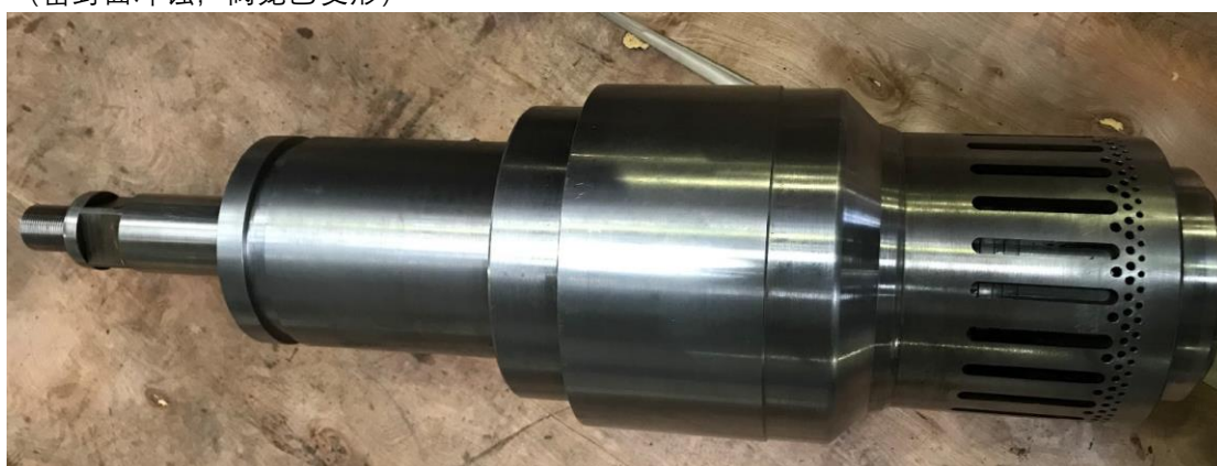
图 19 制造商重新设计制造的阀盖、阀笼、阀芯和阀杆等
