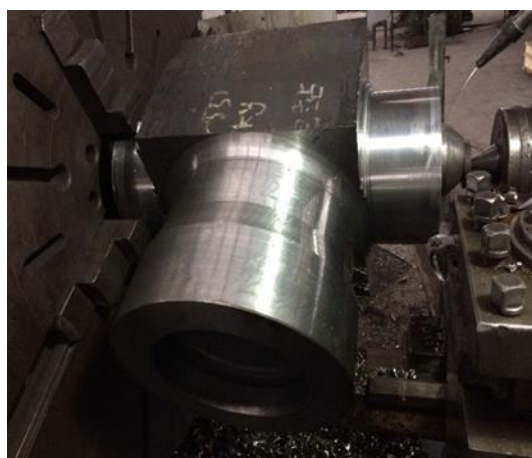
图 36 正在加工的整体锻造闸阀阀体（材料 F91）
