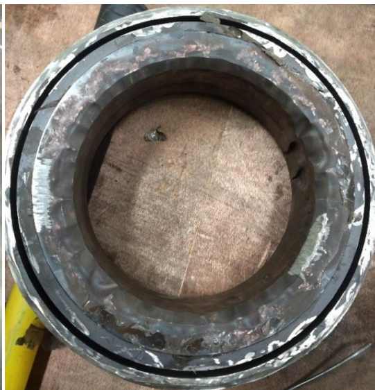
图 7 华能安源电厂高压旁路阀阀座坏（使用不到一年）
