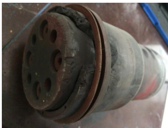
CV 阀芯损坏情况
