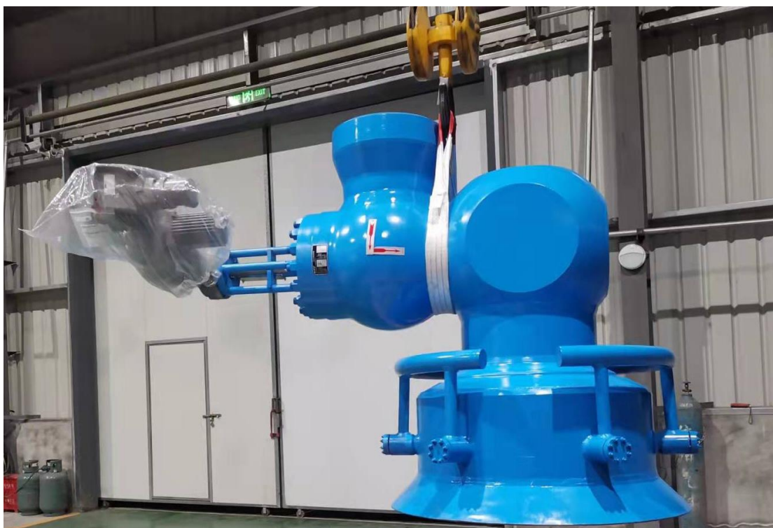
秦皇岛电厂全新设计制造的低压旁路阀（还用于供热）
