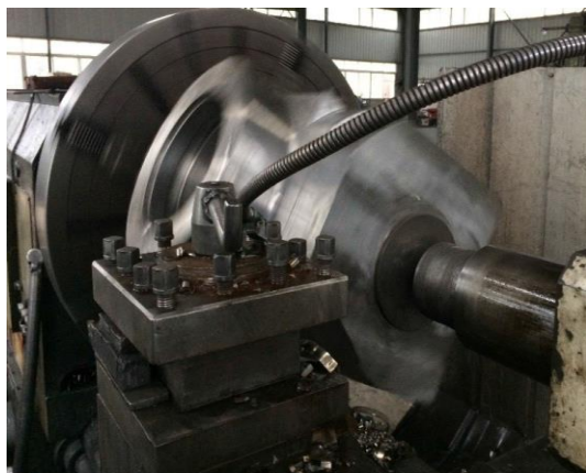
图 33 正在加工的整体锻造抽汽止回阀阀体（材料 F91）
