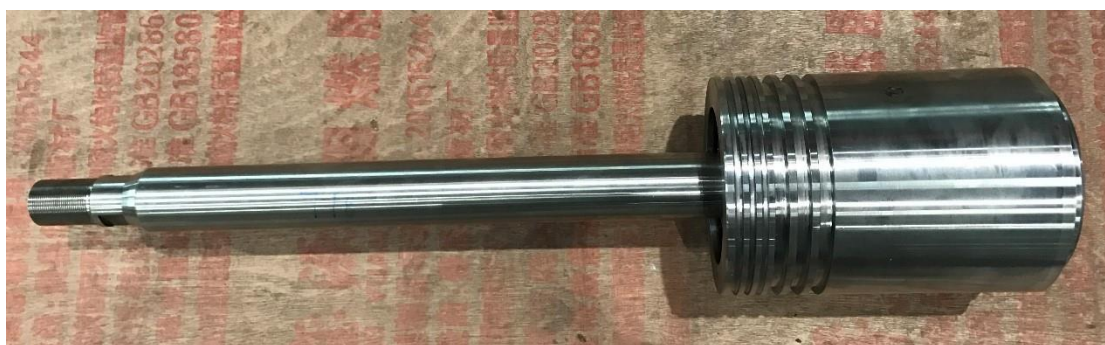
图 14 改造后阀芯和阀杆
