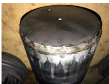
图 17 阀芯密封面 严重冲蚀
