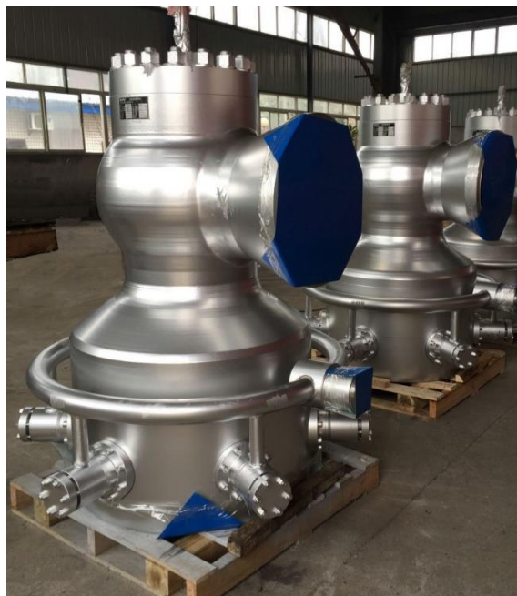
图 2 2015 年 11 月为托克托电厂设计制造的用于 600MW 机组低压旁路阀（材料 F91） 去年机组大修，低压旁路阀都未解体，因为阀后温度一直很低
