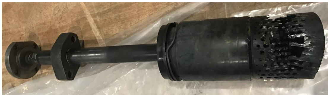
图 13 高压旁路阀阀芯损坏
