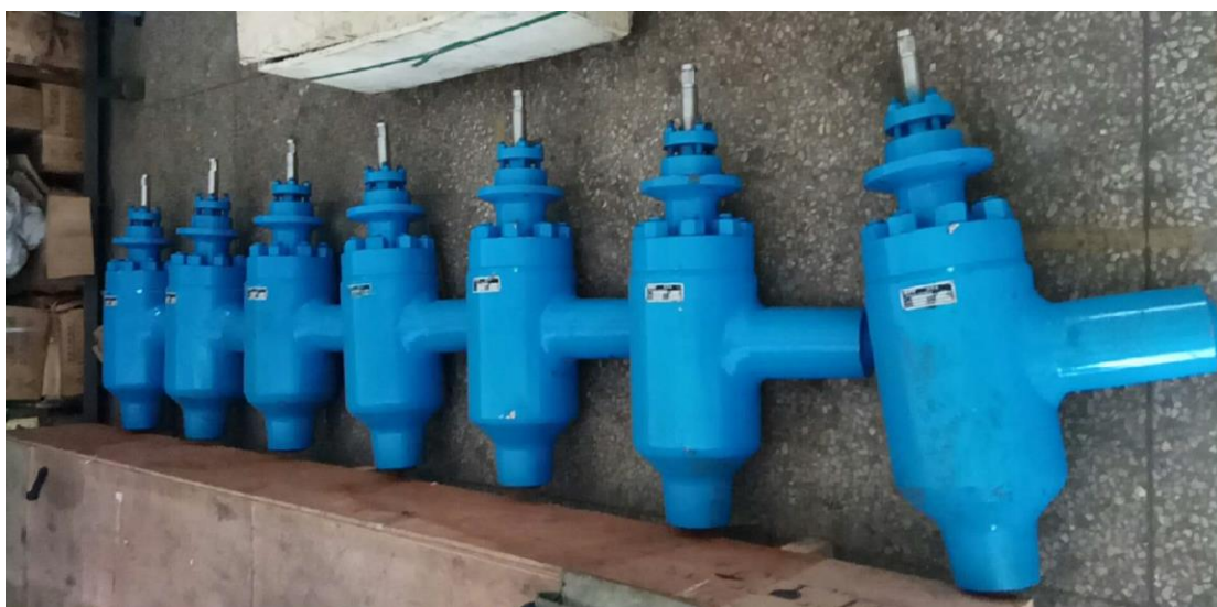
图 49 2017 年 9 月开始对国华徐州电厂 2X1000MW 超超临界机组低压旁路阀全部成功改造后，于 2018 年 7 月对其中一只问题最为严重的过热器减温水调节阀进行了调节阀本体更换。经使用，完全解决了用户提出的原调节阀经常出现的电动执行机构的铜套磨损报废的问题，同时还彻底地解决了原调节阀在机组启机时，一旦投入过热器减温水调节阀，就会引起主蒸汽温度急剧下降（下降温度在 100℃左右）的严重问题，给机组启机带来严重的安全隐患。随后，对其他过热器减温水调节阀进行了更换（使用原调节阀的电动执行机构）。本图是制造商为国华徐州电厂提供的过热器减温水调节阀。随后更换了原进口再热器减温水调节阀（调节阀和喷嘴组为一体，使用中喷嘴被冲断。这种设计能保证在喷水流量变化很大的情况下，减温水的雾化效果，起到保护减温器的作用）。紧接着更换了吹灰蒸汽压力调节阀（原进口调节阀调节性能太差，致使安全阀经常起跳）
