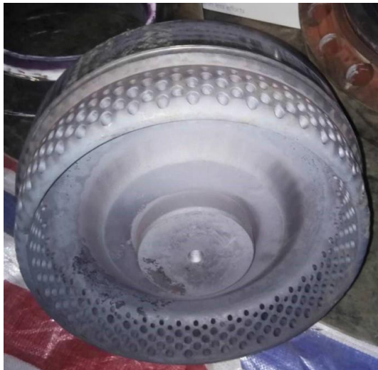
图 30 阀芯密封面冲蚀情况
