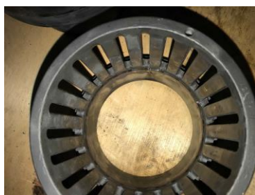
图 16 华能井冈山电厂 高压旁路阀阀座带阀笼 (密封面冲蚀, 阀笼已变形)
