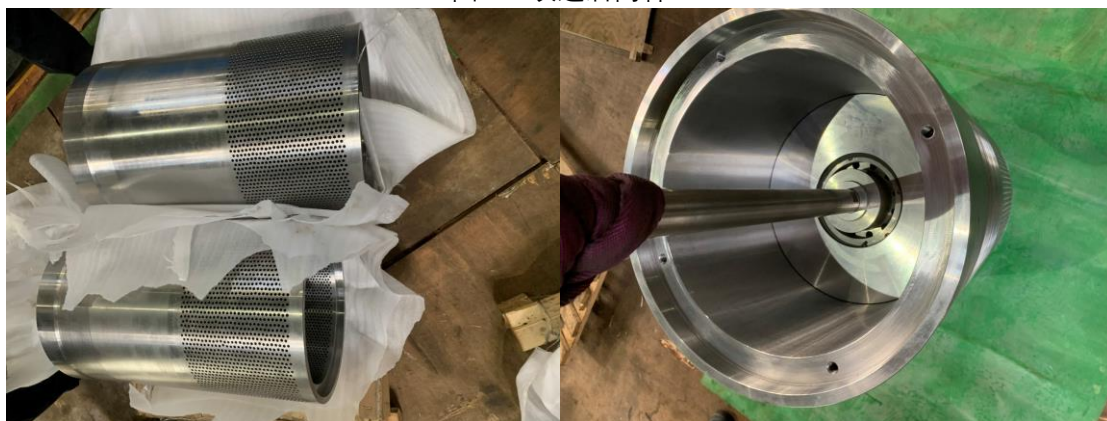
图 11 浙能六横电厂 2*1000MW 超超临界机组低压旁路阀阀笼 (制造商设计制造)
